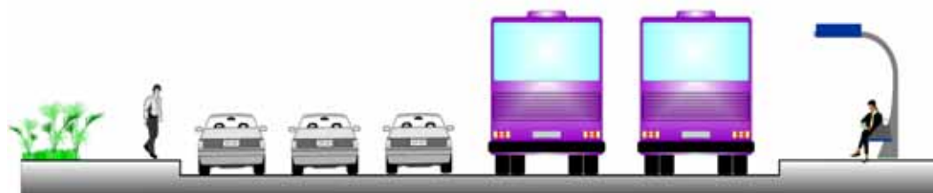
Faixa exclusiva de ônibus junto à calçada, com baía para ultrapassagem
