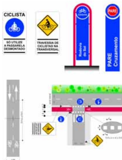
Exemplo de sinalização para bicicletas
