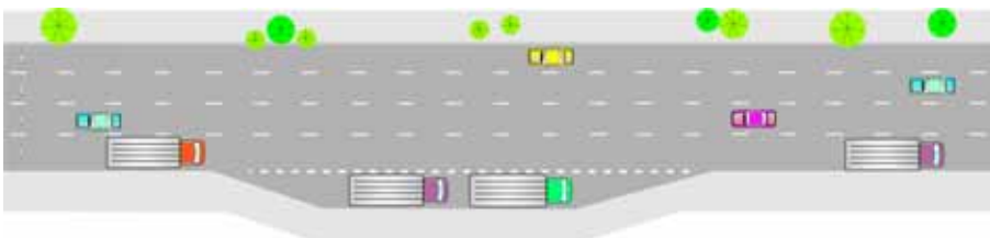
Baia de apoio para veículo de carga
