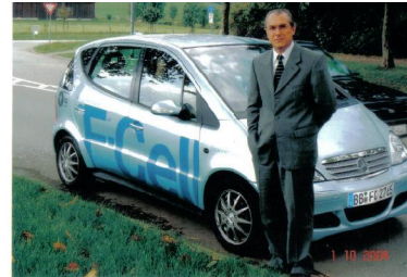
Veículo Classe A que utiliza motorização através de célula a combustível (Hidrogênio). Foi deste veículo que utilizamos as células para o projeto do sistema de tração do ônibus.
