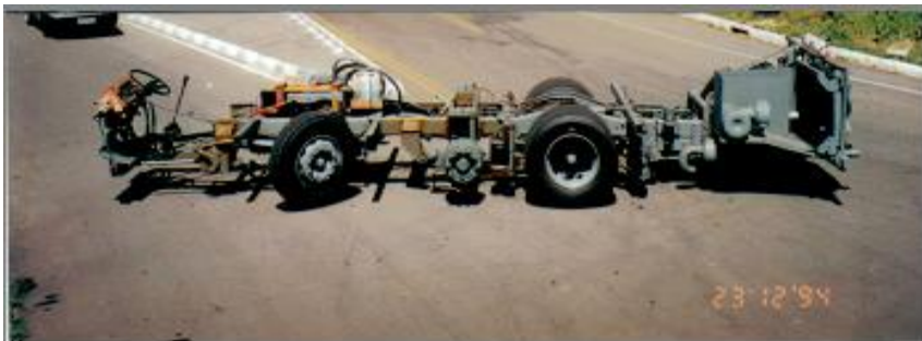
2º Eixo Instalado em Chassi Scania Double Deck
