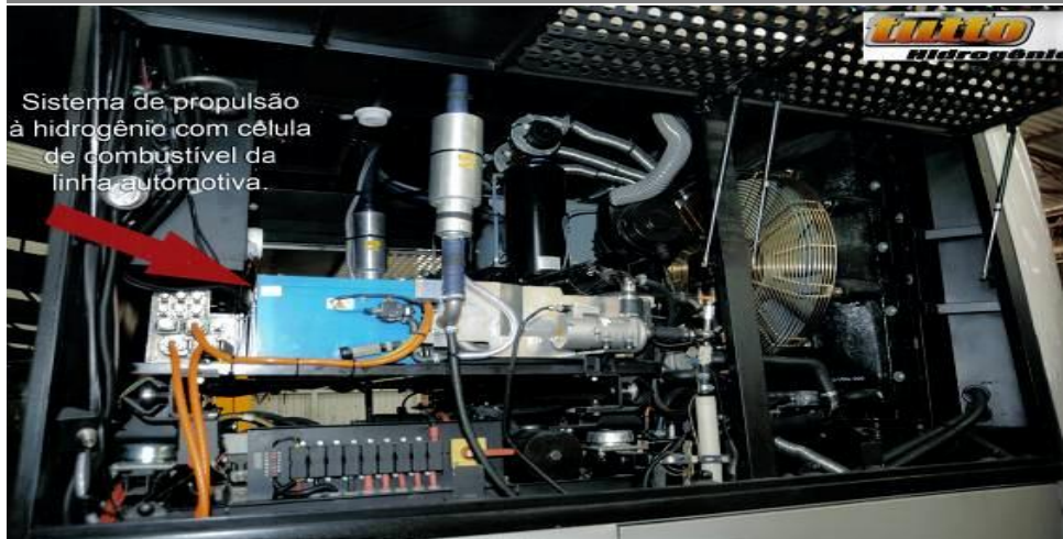
Veículo Classe A que utiliza motorização através de célula a combustível (Hidrogênio). Foi deste veículo que utilizamos as células para o projeto do sistema de tração do ônibus.
